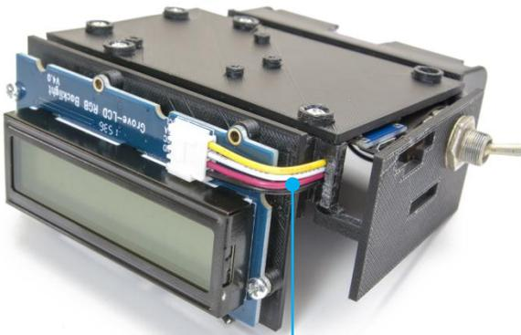
Пропустите провода через прорези в деталях корпуса
